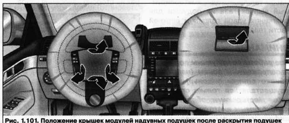
Рис. 1.101. Положение крышек модулей надувных подушек после раскрытия подушек
