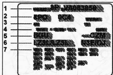
Рис. 1.3. Содержание стикера с данными автомобиля: 1 – производственный номер; 2 – идентификационный номер автомобиля; 3 – маркировка типа; 4 – расшифровка модели/мощность двигателя; 5 – буквенное обозначение двигателя и коробки передач; 6 – код краски/числовой код внутреннего оформления; 7 – числовой код дополнительного оснащения
