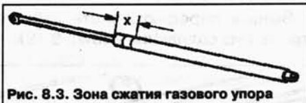
Рис. 8.3. Зона сжатия газового упора
