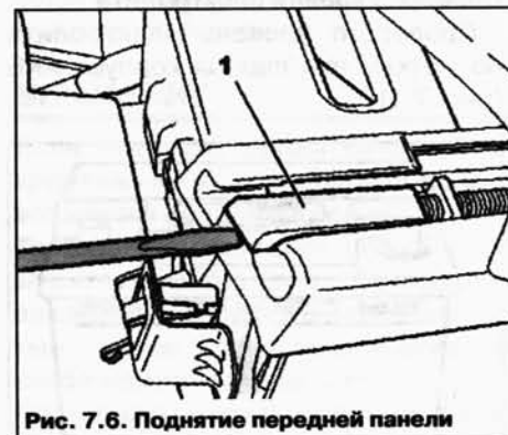
Рис. 7.6. Поднятие передней панели
